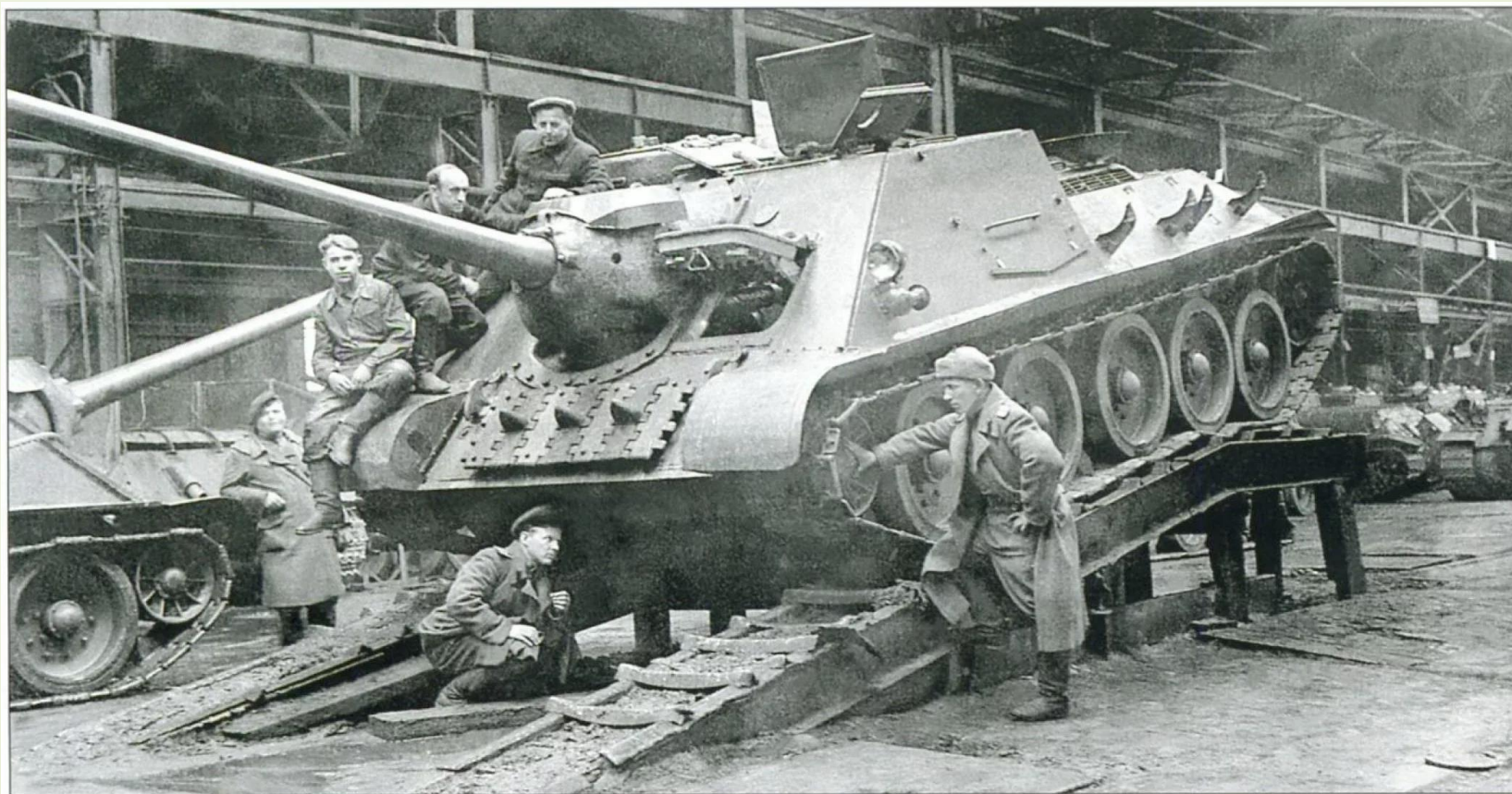
Проверка в цеху УЗТМ последней свердловской самоходки. На левом борту рубки видны приваренные бонки укладки приспособления самовытаскивания. На правом переднем грязевом щитке округлой формы виден вертикальный лючок для приспособления введения в зацепление кривошипа ленивца. Фото из коллекции С. Агеева.
